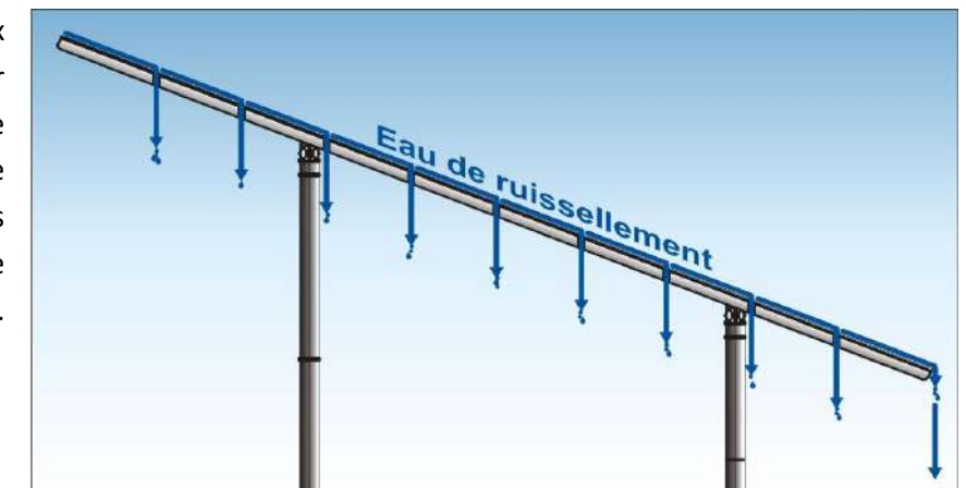
Figure 45. Répartition des panneaux évitant la concentration des eaux (schéma de principe à titre d'exemple)
